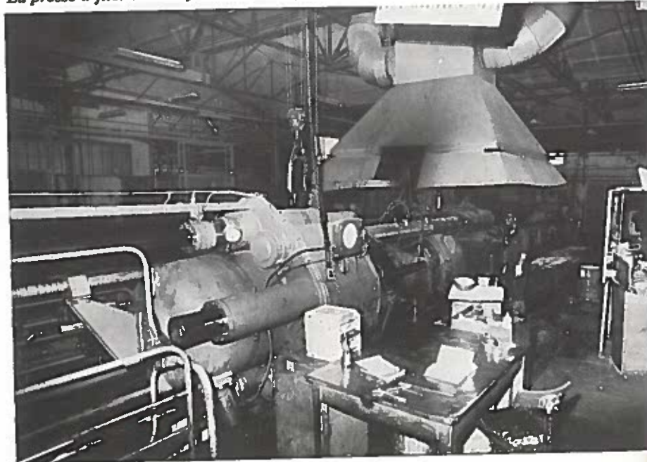
La presse à filer de Noisy : un outil important dans l'élaboration de la brasure
